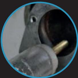
3. Heizrohr in die Öffnung einschieben
