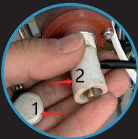
2. Setzen Sie das Keramikrohr auf und verschließen Sie es mit der Keramikcappe
