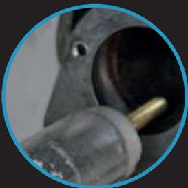
3. Heizrohr in die Öffnung einschieben
